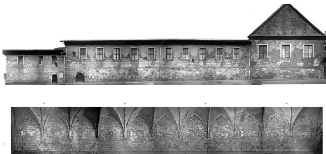
Abb. 2: Kloster Michaelstein, nördlicher Kreuzgang, digitaler Bildplan, Originalmaßstab 1:50, Einarbeitung eines einheitlichen Lage- und Höhensystems (Grundlage für die Sanierungsplanung und die Kartierung der Befunde), oben: nördlicher Kreuzgang, Außenseite (Montage aus sechs entzerrten Einzelbildern), unten: nördlicher Kreuzgang, Innenseite (Montage aus sechs entzerrten Einzelbildern)
