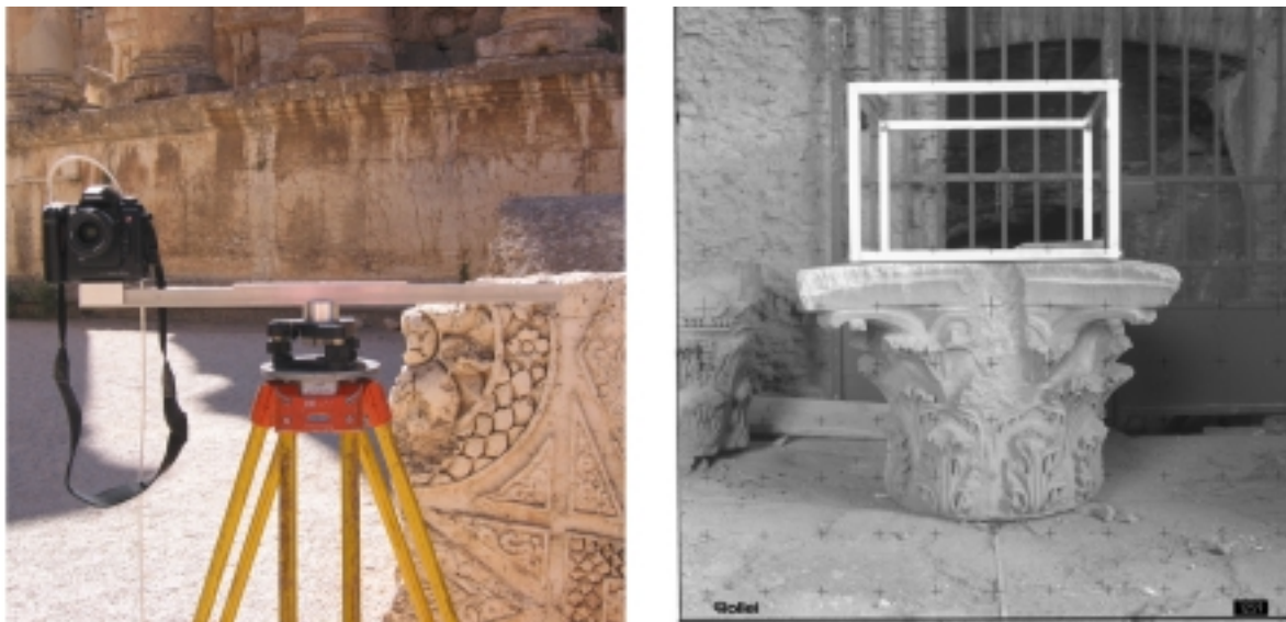
Abb. 1: Aufnahmeconfiguration vor Ort (links: Kameraschiene als Basis, rechts: Rahmen als 3D-Maßbezug)
