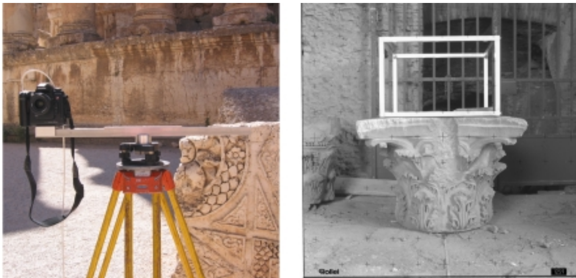
Abb. 1: Aufnahmekonfiguration vor Ort (links: Kameraschiene als Basis, rechts: Rahmen als 3D-Maßbezug)
